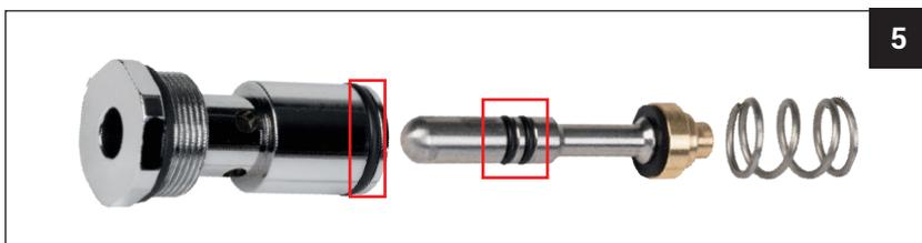
Retirar los restos de cal o suciedad, especialmente en las juntas indicadas. Engrasar y ensamblar nuevamente.
