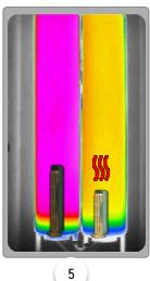
El tanque de entrada se calienta hasta la temperatura establecida en función de la temperatura seleccionada
