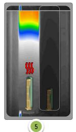
El sensor del tanque de salida detecta agua a temperatura más baja de la establecida y activa la resistencia, apagándose la resistencia del tanque de entrada
