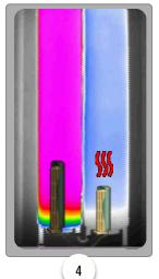
La resistencia del tanque de salida del agua se apaga y se pone en marcha la resistencia del tanque de entrada
